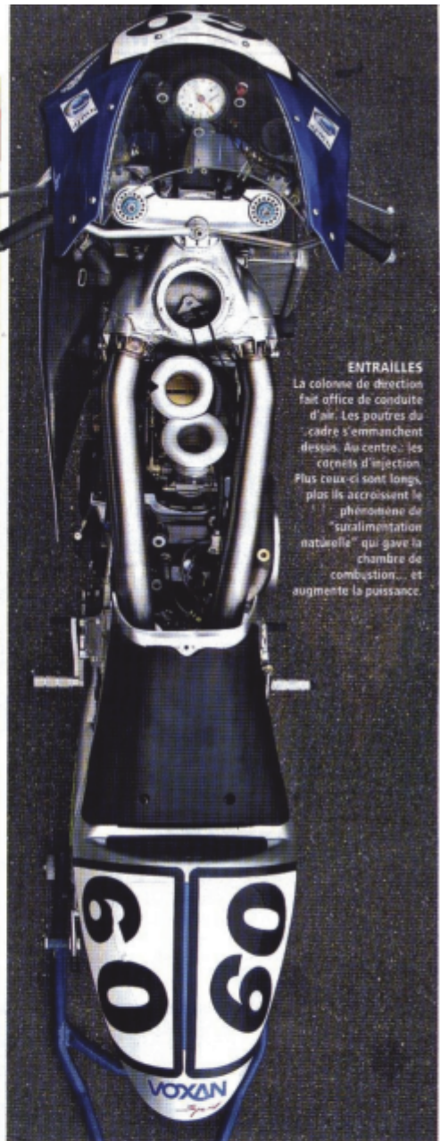
Proto VOXAN 1000 Protwin Puissance au vilo 143 ch Poids tous pleins faits 182 kg CHIFFRES CONSTRUCTEUR
